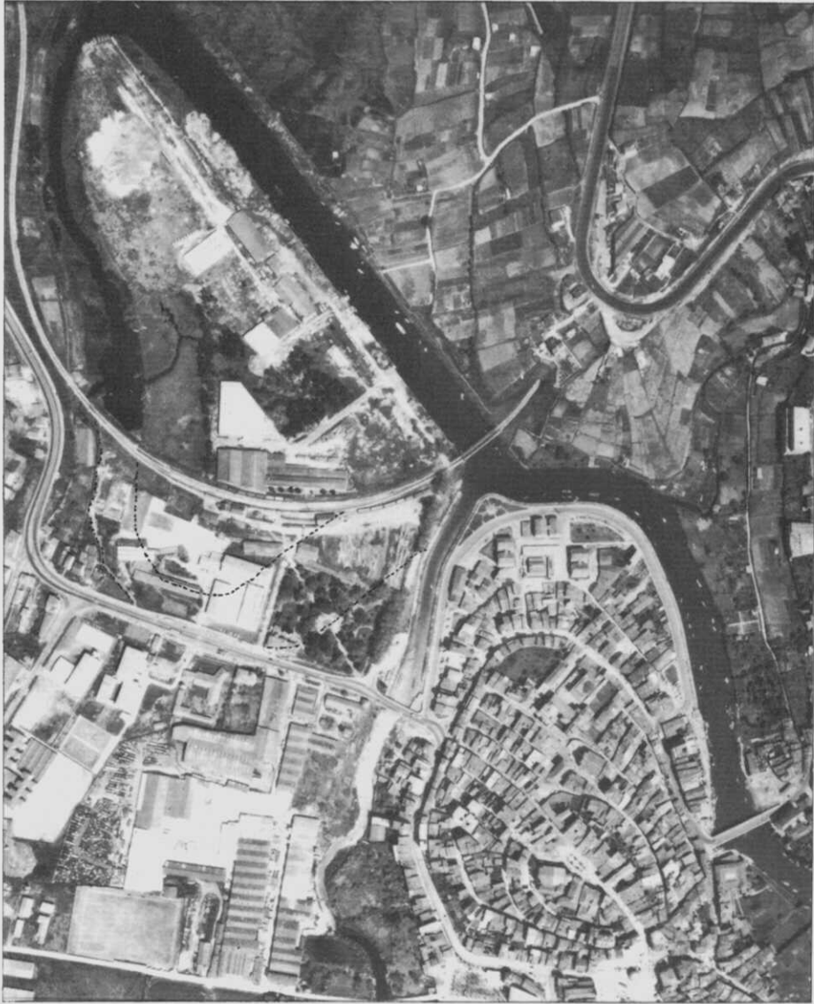
13) Fotografía aérea de 1981 na que se pode ver o novo canle artificial da ría, completamente recto, mais tamén parte do leito vello que aínda permanece. O que xa non se ve reconstruímoso con pontos.
