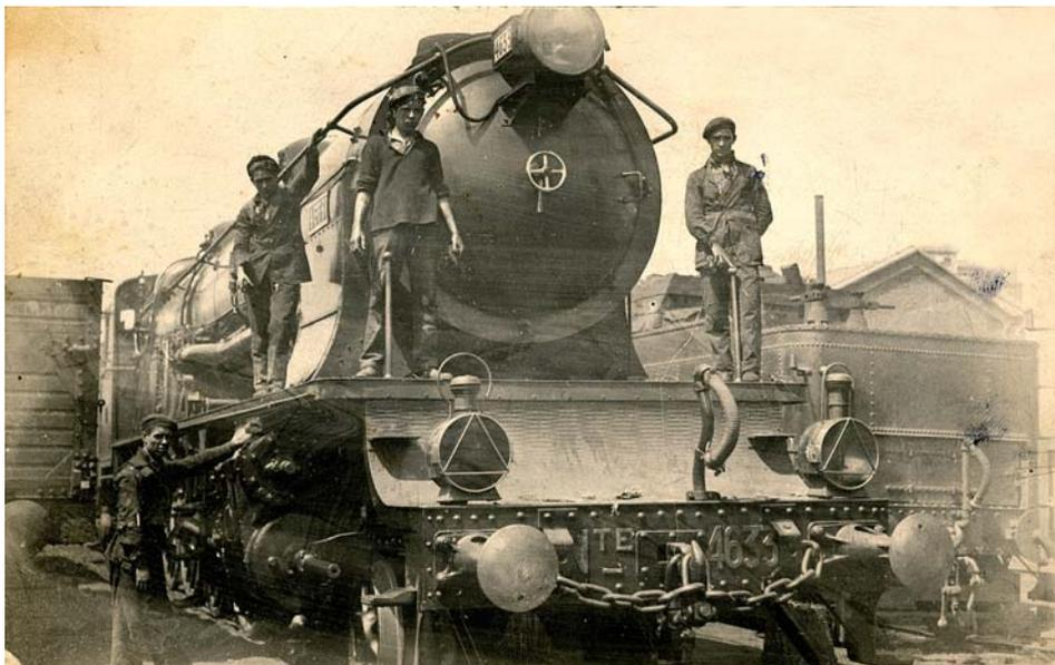
*Ferrovionario en una máquina de vapor. Década de 1930. Mastodonte 240-4045 Ex Norte 4001-4065 construidas por S. A. C. M. (francesa) y Henchel (alemana) entre 1912 y 1921.*
