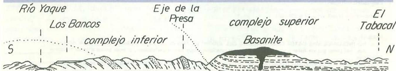
FIG. 332 EL ESTUDIO GEOLOGICO DEL EMPLAZAMIENTO DE LAS PRESAS, Y DEL AREA DE SUS EMBALSES, ES CLAVE PARA DETERMINAR SU FACTIBILIDAD TECNICA Y FINANCIERA. El dibujo muestra la sección geológica del emplazamiento de la Presa de Sabana Yegua, de N. a S., a lo largo de la orilla derecha del Yaque Sur. Fuente: ITACONSULT.
