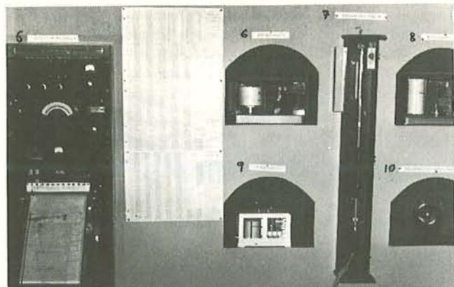
FIGS. 323 y 324 PANELES DEL SMN, EN LA FERIA GANADERA: 1) Programas de observaciones fenológicas, 2) clasificaciones climatológicas de la RD. 3) Bioclimatología RD. 4) Temperatura y ganadería, 5) Receptor de radiosondeos. 6) Anemógrafo. 7) Barómetro Fortín. 8) Microbarógrafo. 9) Termógrafo. 10) Solarímetro—Heliofanógrafo. Fotos: DE LA FUENTE, S.
