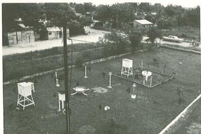
FIG. 325 ESTACION CLIMATOLOGICA en la sede central del SMN, SD: 1) "garita" con Termohigrógrafo, Termómetros de Máxima y mínima y Psicrómetro, 2) Rociógrafo. 3) Pluviómetro. 4) Heliógrafo. 5) Evaporímetro "Piché". 6) Tanque de Evaporación, con Anemómetro totalizador anexo. 7) Piranógrafo. 8) Rociógrafo y 9) Pluviógrafo. Esta área es la "Estación Climatológica de Enseñanza", constituyendo "B" la "Estación Climatológica tipo". Foto: SMN. (VER Ap. 34 y sigs).
